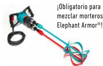
ColloMix Xo 55 Duo – Trabajo pesado simplificado La gran carga de fibra de Elephant Armor® produce una mezcla altamente viscosa por lo que el Col loMix Xo 55 Duo es obligatorio para generar el alto cizalla- miento necesario para lograr una mezcla homogénea en los morteros Elephant Armor®. Por lo general lograterminar el mezclado en la mitad del tiempo.
